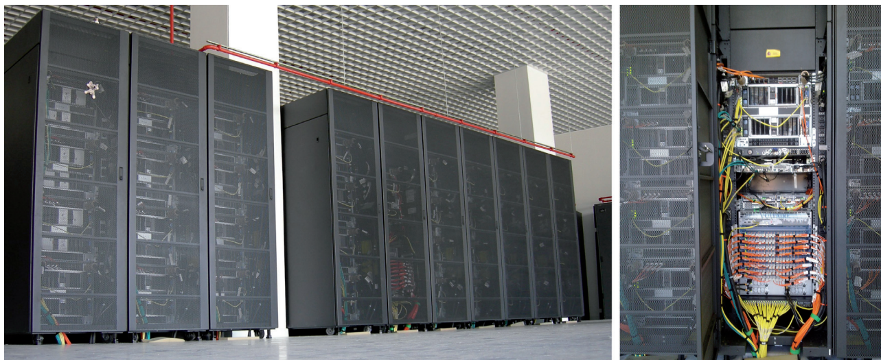
Foto 2. Sistema Magerit con 2.864 CPUs y 6,9 TB de RAM. Recursos de supercomputación disponibles para el proyecto, ofrecidos por CeSViMa (Centro de Supercomputación y Visualización de Madrid) en la UPM. / Foto cedida por el autor.
