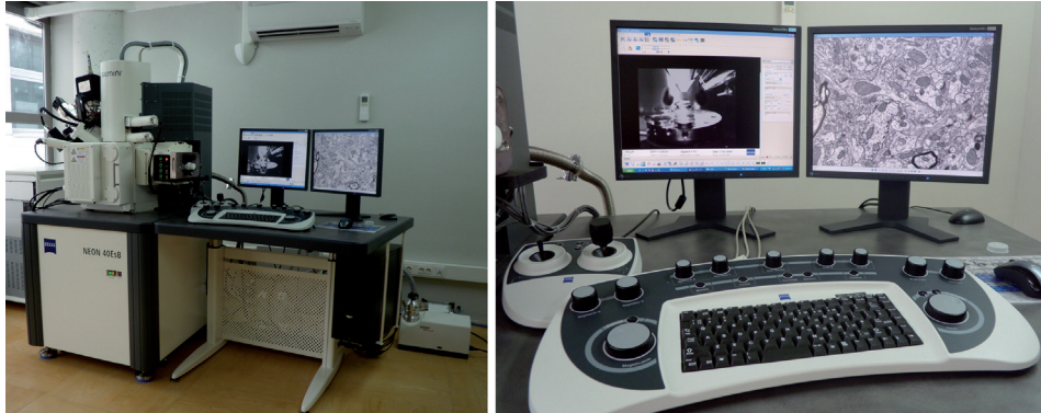
Foto 1. Sistema FIB-SEM de Zeiss (Microscopio Cross Beam NEON 40 EsB). / Foto cedida por el autor.
